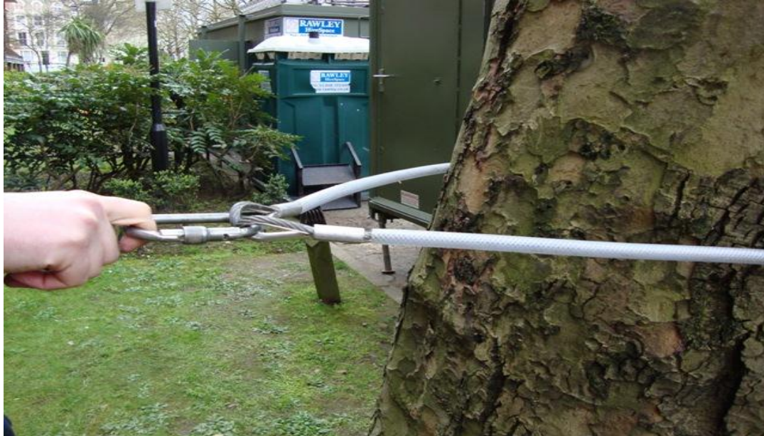
Foto 1: Cinta colocada como âncora principal. Estavam quatro destas juntas para ancorar quatro cordas.
