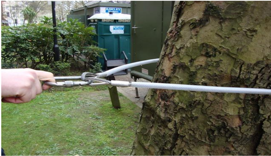
Gambar 1: Strop ditetapkan sebagai Penambat Utama. Terdapat empat strop serentak untuk menambat empat tali.
